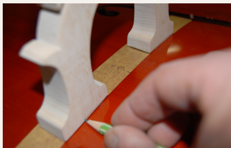
Foto 2: Teken de plaatsing van de nieuwe kam nauwkeurig af
